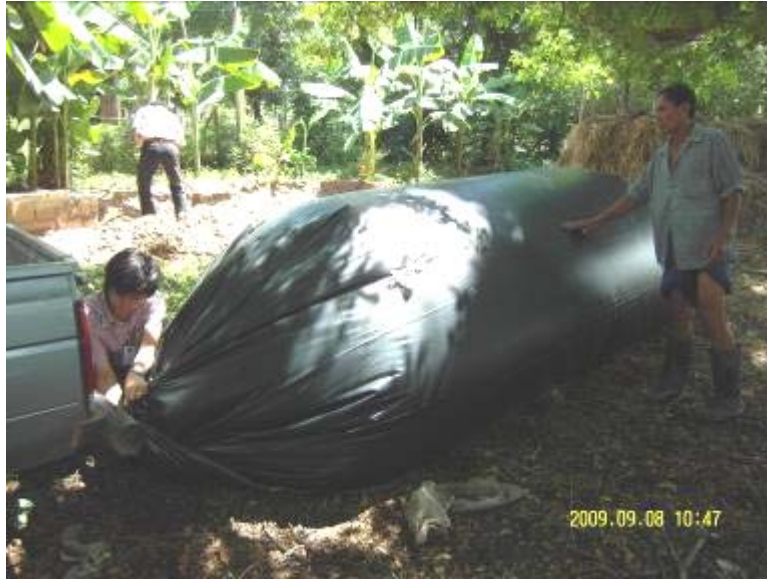
รูปที่ 11 แสดงขั้นตอนการทดสอบการรั่วของถุงด้วยไอเสียจากรถยนต์
