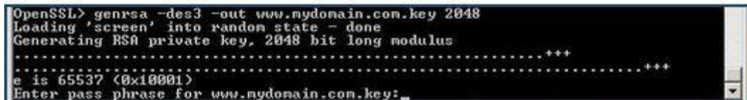
ภาพที่ 3 การใช้ command line ในการสร้างทั้งกุญแจคู่รหัสไฟล์ CSR
